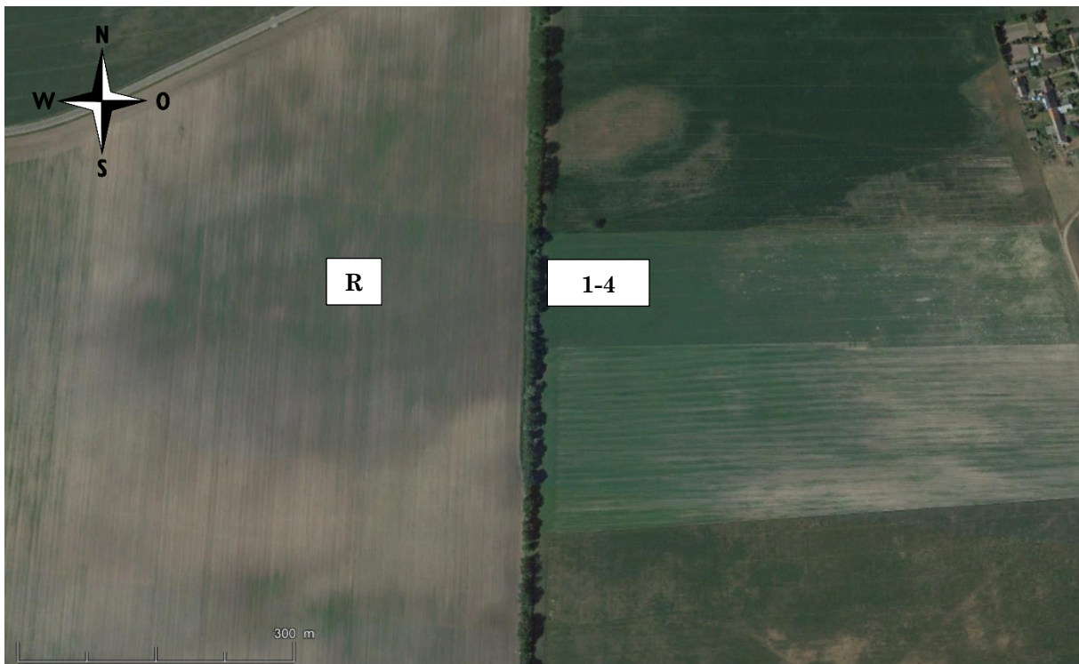
Abbildung 12: Lage der Windsensoren am Standort Lichtena (R = Freiflächenreferenz für Windgeschwindigkeit sowie Position des Windrichtungssensors; 1, 2, 3 und 4 = Anemometer im Windschutzbereich einer Pappelwindschutzhecke im Abstand von 12 m, 24 m, 48 m und 96 m zu dieser; Quelle des Luftbildes: Google Earth)
