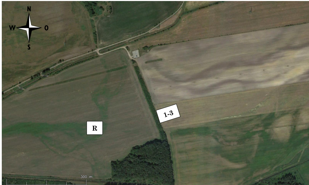
Abbildung 10: Lage der Windsensoren am Standort Biehlen (R = Freiflächenreferenz für Windgeschwindigkeit sowie Position des Windrichtungssensors; 1, 2 und 3 = Anemometer im Windschutzbereich einer naturschutzfachlich hochwertigen Hecke im Abstand von 12 m, 24 m und 48 m zu dieser; Quelle des Luftbildes: Google Earth)
