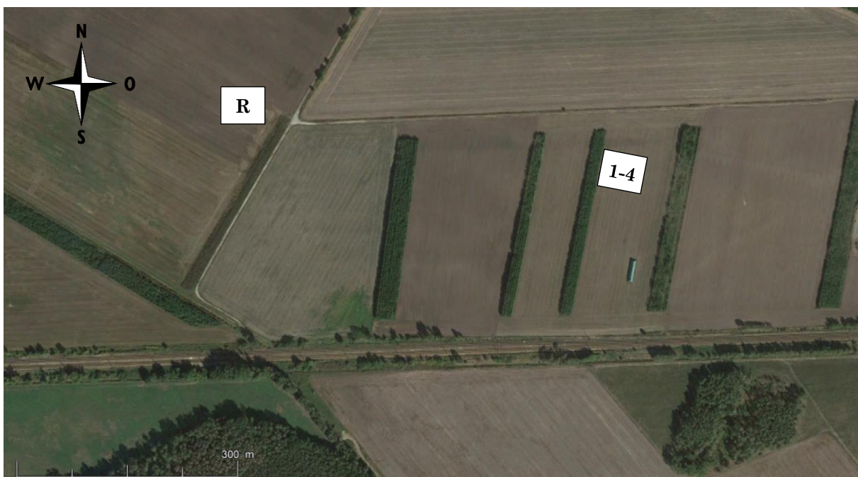
Abbildung 6: Lage der Windsensoren auf der Agroforstfläche Peickwitz (R = Freiflächenreferenz für Windgeschwindigkeit sowie Position des Windrichtungssensors; 1, 2, 3 und 4 = Windgeschwindigkeitssensoren auf einem 60 m breiten Ackerkulturstreifen in 6 m, 12 m, 24 m und 48 m Abstand vom westlich gelegenen Gehölzstreifen; Quelle des Luftbildes: Google Earth)
