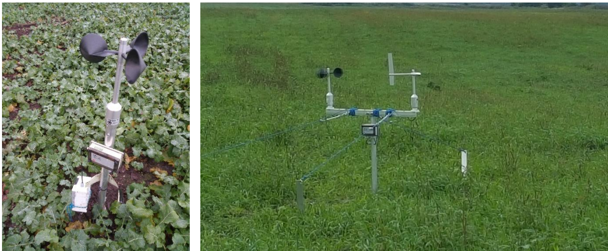
Abbildung 1: Windgeschwindigkeitssensor (links) und Windgeschwindigkeitssensor mit Windrichtungssensor (rechts) „First-Class advanced“ der Firma Adolf Thies GmbH & Co. KG
