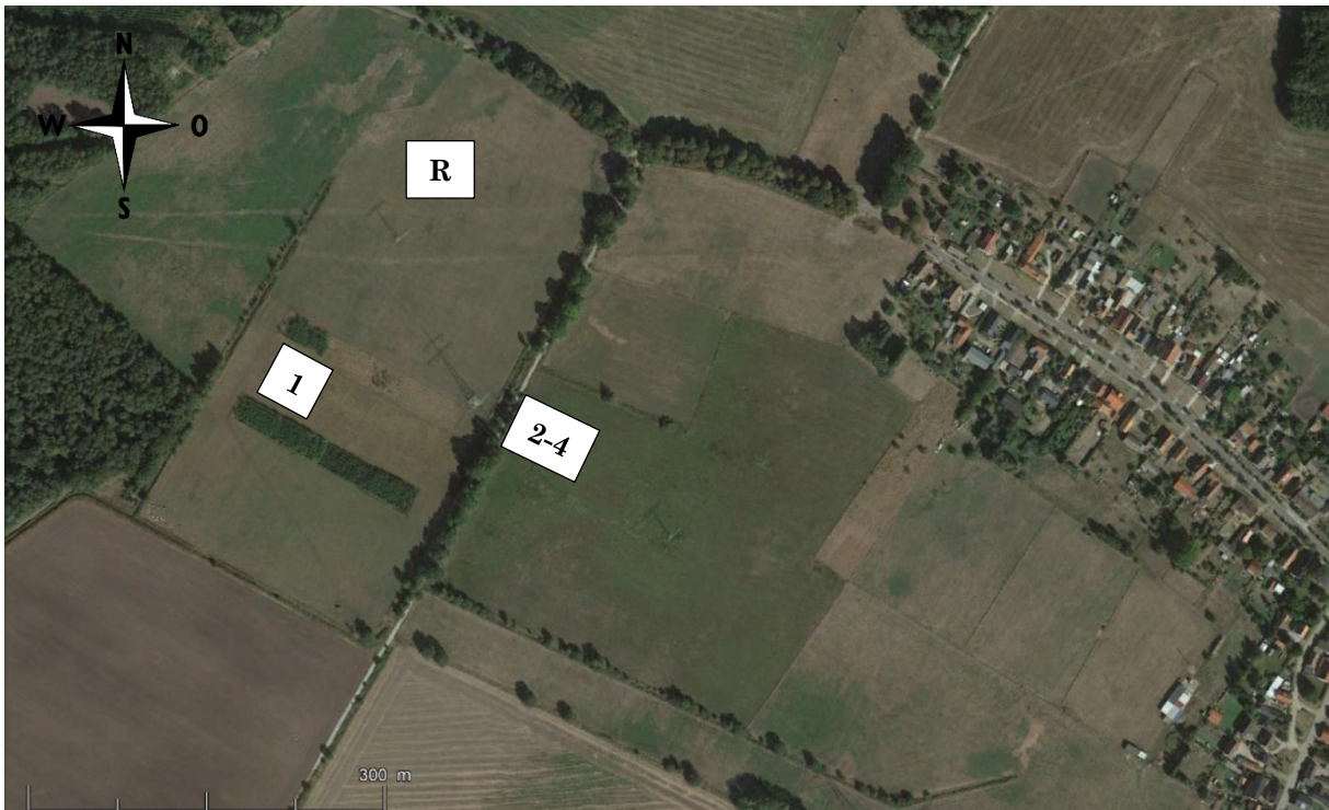
Abbildung 8: Positionen der Windsensoren auf der Grünlandfläche Peickwitz (R = Freiflächenreferenz für Windgeschwindigkeit sowie Position des Windrichtungssensors; 1 = Anemometer auf einer 60 m breiten Grünlandfläche zwischen zwei Agroforstgehölzstreifen; 2, 3 und 4 = Windgeschwindigkeitssensoren östlich einer an einem Weg befindlichen Hecke im Abstand von 12 m, 24 m und 48 m zu dieser; Quelle des Luftbildes: Google Earth)
