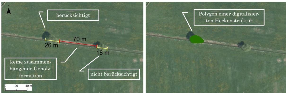
**Abbildung 1:** Auswahl von für die Digitalisierung relevanten Gehölzstrukturen (links) und Digitalisierung eine Gehölzstruktur entlang der Gehölzkrone (rechts)
