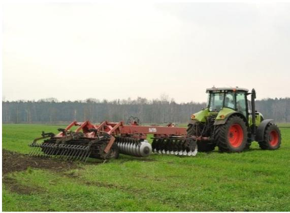
**Abbildung 4:** Einsatz einer Scheibenegge zum Ziehen der Reihen
