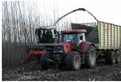
b) Hackschnitzeltransport mit Abschiebewagen
