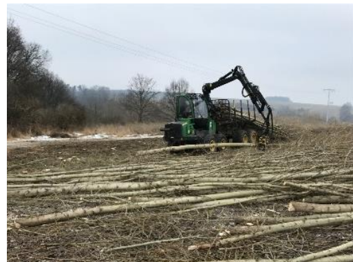
e) Rückezug zum Transport zum Zwischenlager am Feldrand
