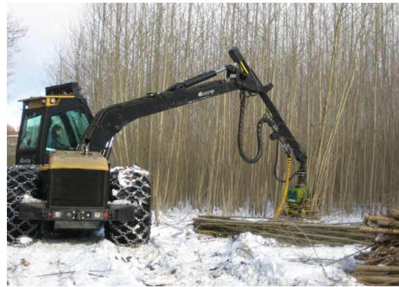
b) EcoLog Harvester 560 C mit Energieholzaggregat Lignis (Foto: Schweier)
