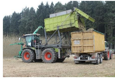
c) Feldtransport mittels auf der Erntemaschine montiertem Überladebunker
