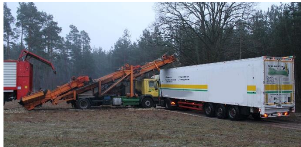
e) Mobiles LKW-Förderband zum Überladen vom Abschiebewagen (Feldtransport) auf Schüttgut-LKW für den Straßentransport
