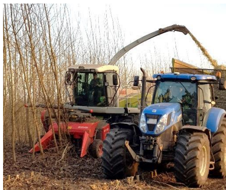
Claas Jaguar 900 mit Vorsatz HV 1400 (Fa. Wimatec)
