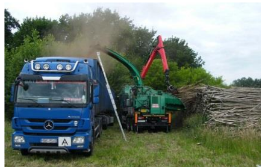
g) Nachhacken der gelagerten/ getrockneten Bäume
