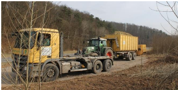
d) Containerwechsel zwischen Feld- und Straßentransport
