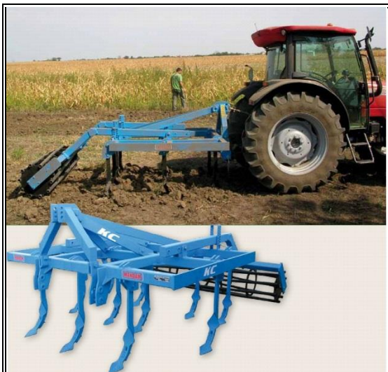
Abbildung 2: Schwergrubber mit Rohrwalze
