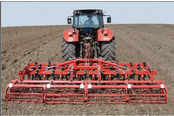
Abbildung 3: Federzinkengrubber mit Krümelwalze
