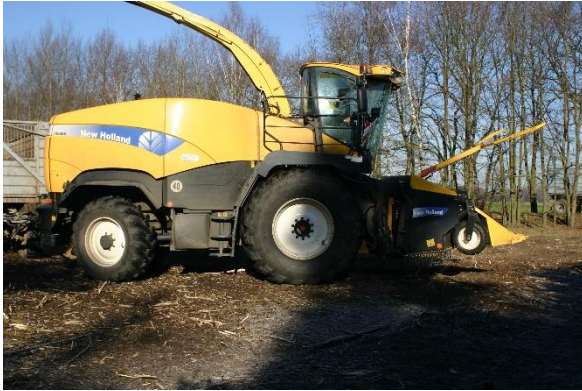
Abbildung 1: Feldhäcksler mit Gehölzgebiss der Fa. New Holland
