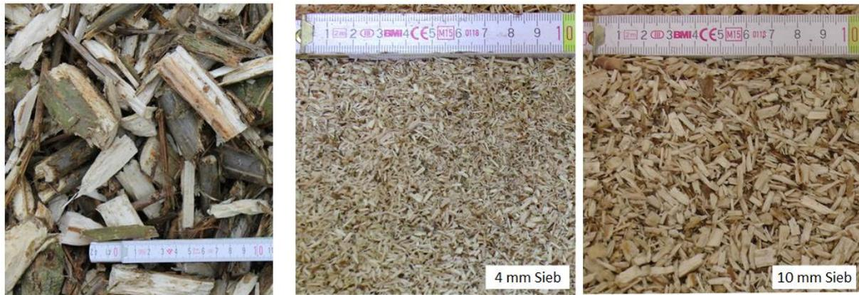
**Abbildung 2:** Pappelhackschnitzel der Größenklasse P31 und daraus hergestellte Pappelspäne (durch Aufbereitung mit einer Schneidmühle mit 4 mm und 10 mm Sieb)
