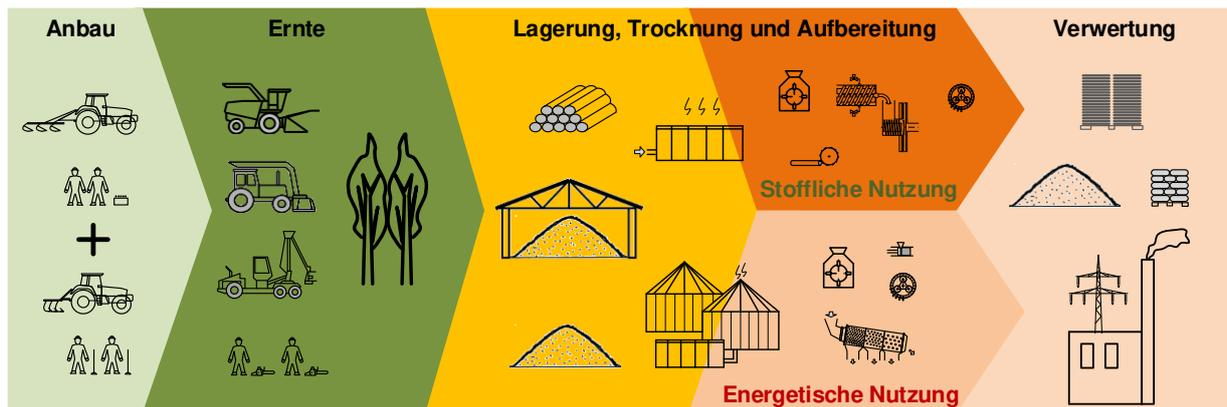
**Abbildung 1:** Bereitstellungs-kette von Holz aus Agroforstsystemen und Einordnung der Aufbereitung für die stoffliche und energetische Verwertung
