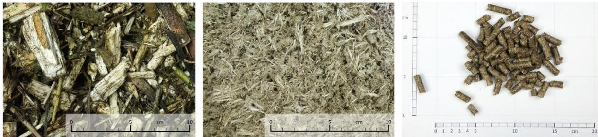
**Abbildung 3:** Pappelhackschnitzel (erntefrisch (links)), daraus hergestellter Faserstoff für Pflanzsubstrate (Mitte) und Einstreupellets (rechts)
