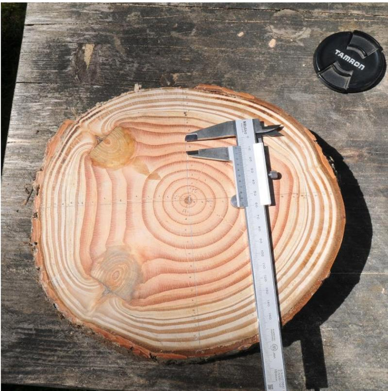
Abbildung 4: Zuwachsmessung an einer Douglasie. Der verwendete Messschieber verfügt über eine Genauigkeit von 0,02 mm. Die Jahrringe sind deutlich zu erkennen, ebenso der Zeitpunkt der Astung, an dem die Äste aufhören. Die Messung erfolgte in vier Richtungen, im je 90 Grad Winkel zueinander.
