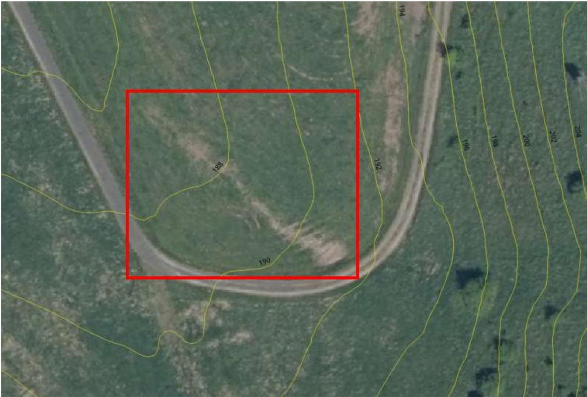
Abbildung 18: Erosionsrinnsal in Talsenke, sichtbar auf einem DOP20
