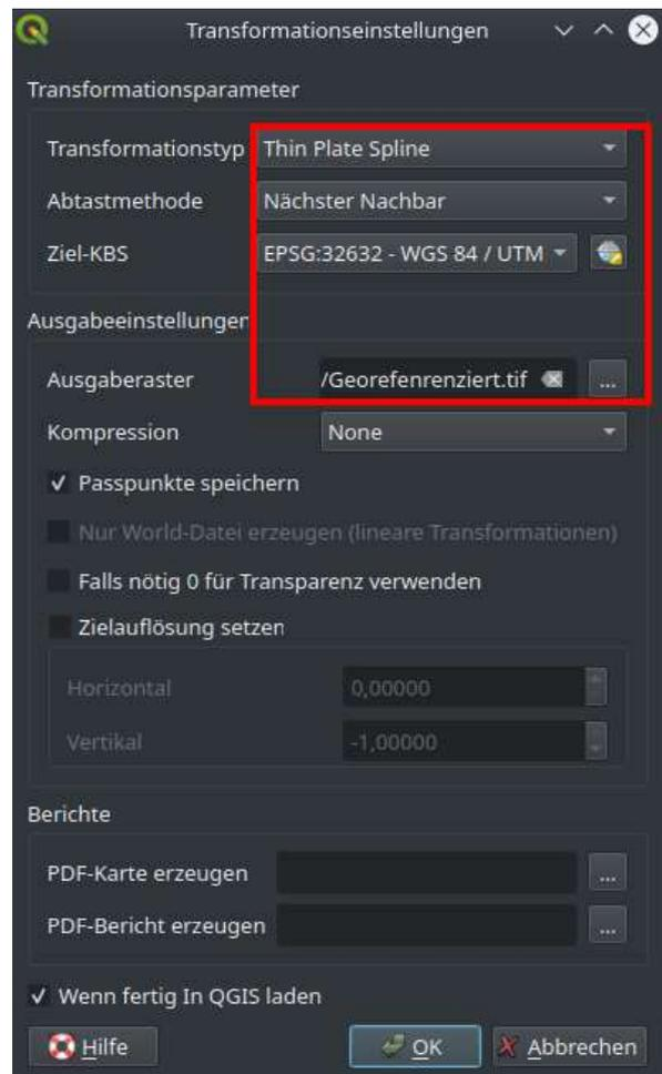
Abbildung 21: Transformationseinstellungen bei der Georeferenzierung einer Karte
