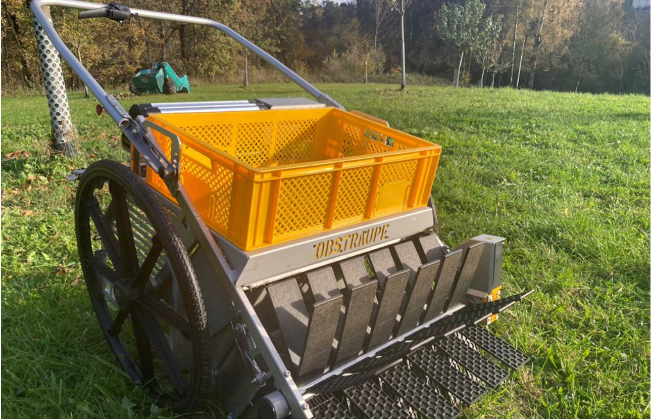
Abb 25 Moderne Maschinen wie die "Obstraupe" aus Österreich eignet sich eine rüchenschonende Ernte und können so die Handarbeit etwas erleichtern. Foto:R. Hübner
