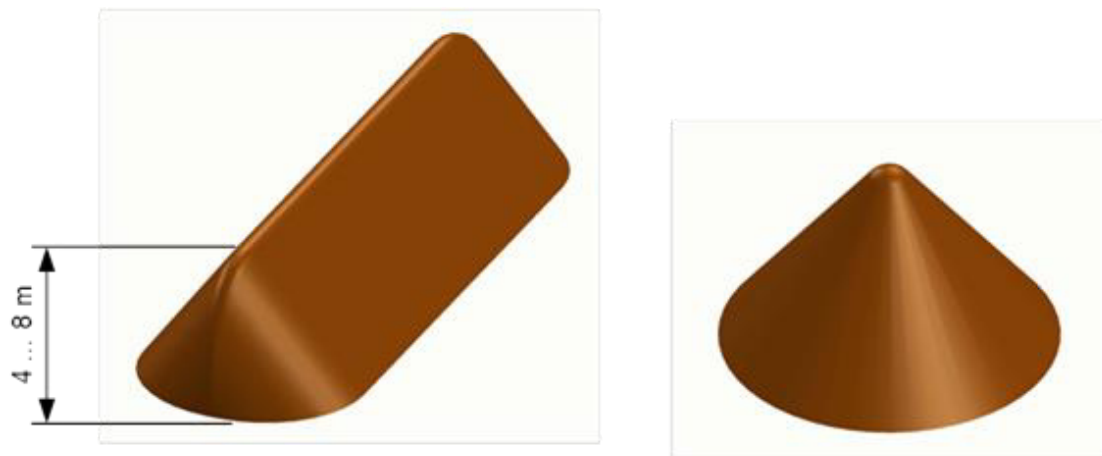
Abbildung 3: Günstige Gestaltung von Freihäufen für die Lagerung von Hackschnitzeln
