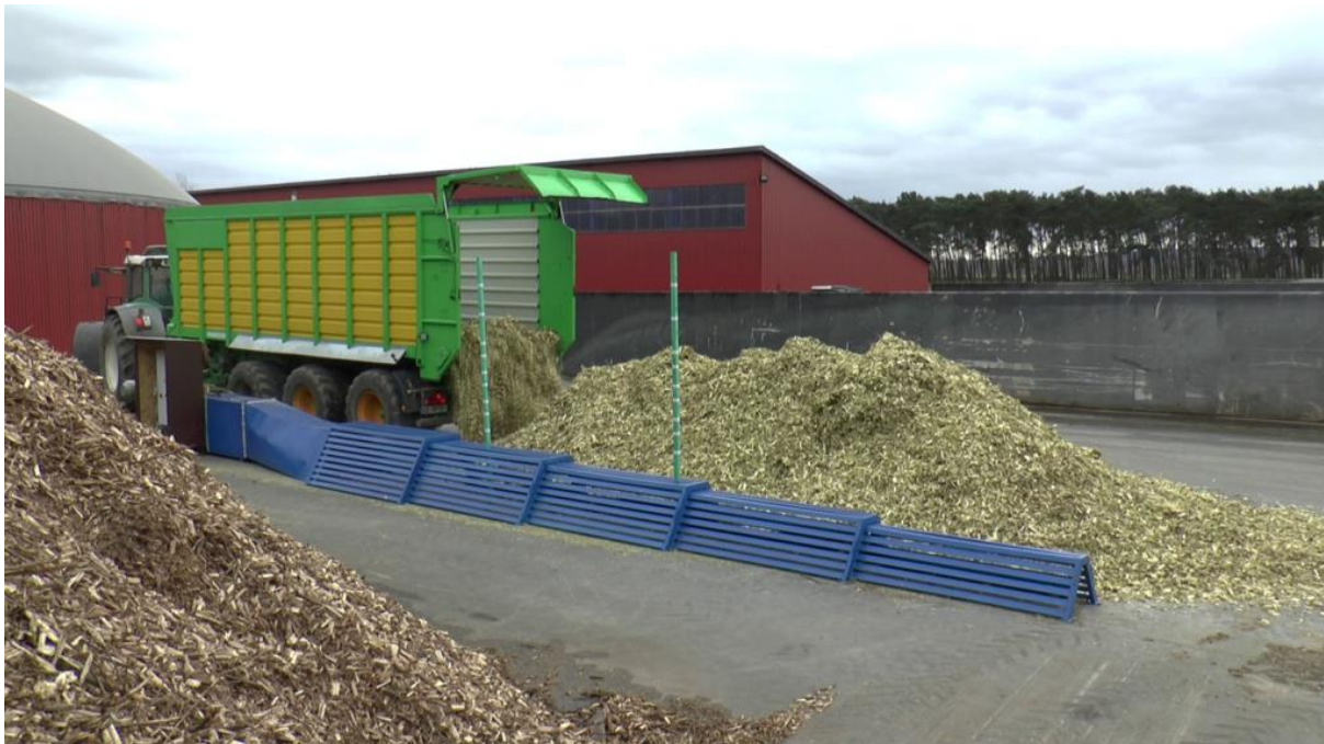
Abbildung 11: Praxisversuch zur Kaltbelüftung von Pappel-Hackschnitzeln (oben: Aufbau des Gesamtsystems, unten: Darstellung des teleskopierbaren Belüftungskanals vor der Befüllung)
