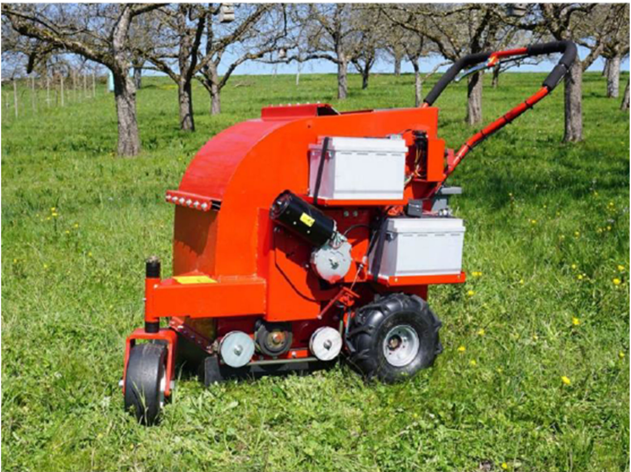
Abbildung 3 Obstauflesemaschine mit Elektroantrieb
