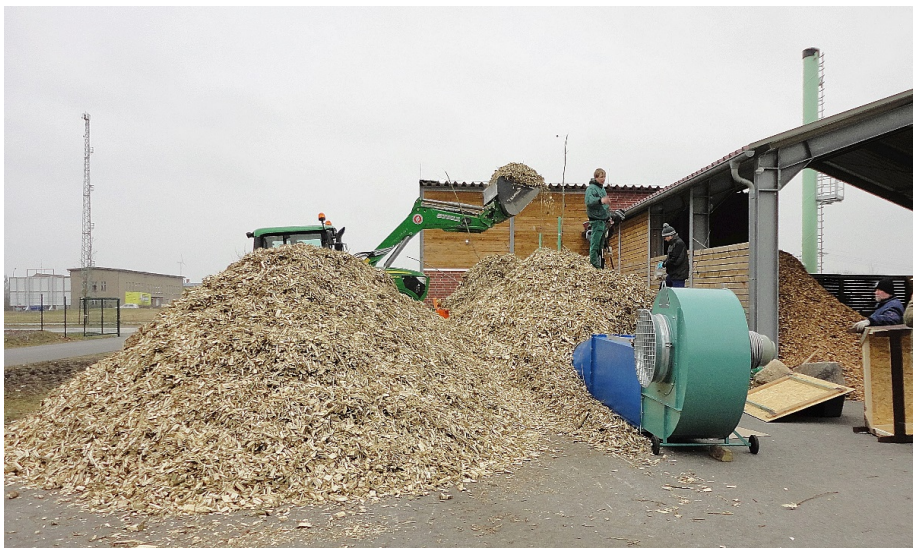
Aufbau des Trocknungs- versuches des ATBs neben dem Heizwerk (Foto: AKE)
