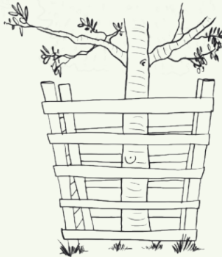
3) Großzügige und stabile Holzkonstruktion für die Beweidung mit Kühen oder Pferden
