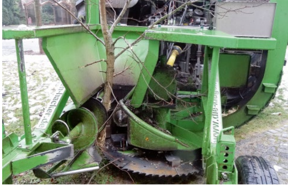
Neue Verfahren erfordern technische Entwicklungen: Blick in einen Anbau-Mähacker zur Ernte von Kurzumtriebsplantagen.
