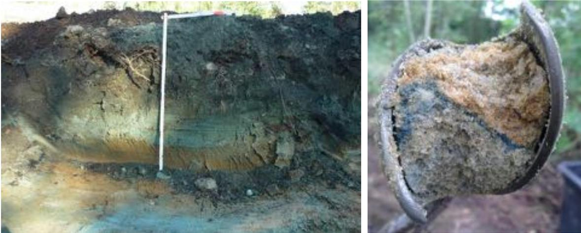
**Abbildung 3:** Cyanidkontamination, sichtbar als „Berliner Blau“ in einem Schurf (links) und in einer Bohrung in ca. 2 m Tiefe (rechts)
