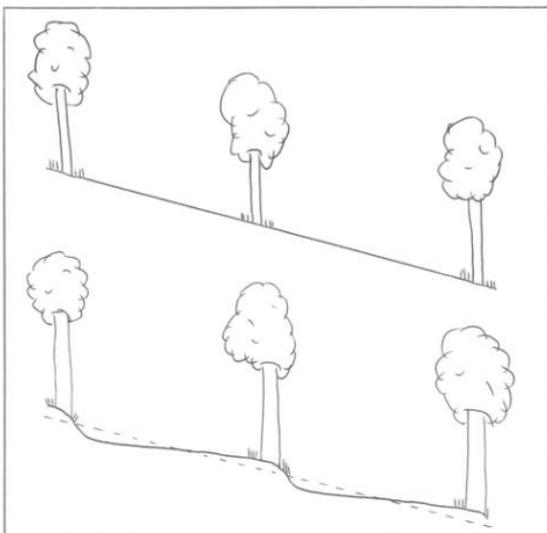
Abb. 3: Schematische Darstellung der langfristigen Terrassenbildung<sup>17</sup> durch Erosion und Sedimentablagerung an Gehölz- bzw. Baumstreifen (vgl. AßMANN&OELKE, 2010, 20 nach BLANCO&LAL 2008).
