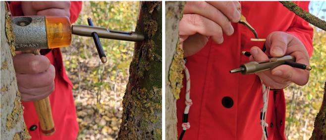
minimalinvasive Probenahme mittels Trephor-Sampler
