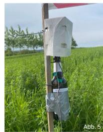
Abb. 3: Versuchsaufbau des Feldversuches; Abb. 4: Ertragserhebung mit 0,5m<sup>2</sup> Schnitten; Abb. 5: Selbstentwickelter Sensor für die Messung der Trocken-/Feuchttemperatur
