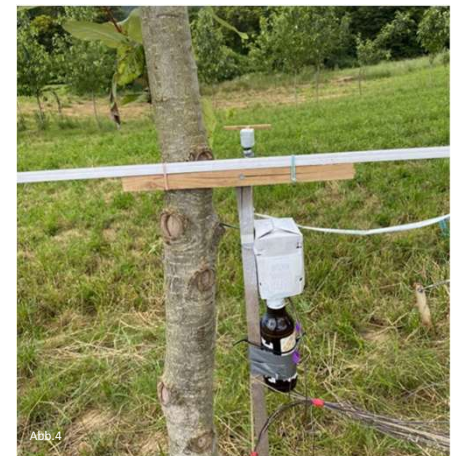
Abb. 3: Thermoelemente zur Temperaturmessung, trocken und mit Selbstbewässerungsdocht Abb. 4: LED-Sensoren zur Strahlungsmessung und Strahlungsschild der Temperatursensoren
