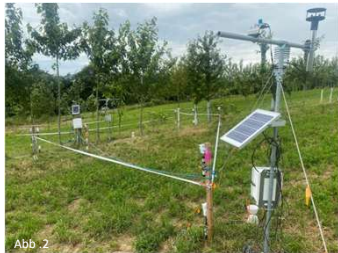
Abb. 2: Aufbau des Messsystems im Agroforst mit selbstgebauten und kommerziellen Sensoren
