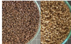
Komposite mit pflanzlichen Füllstoffen als Granulat für den 3D-Druck (@GMBU)
