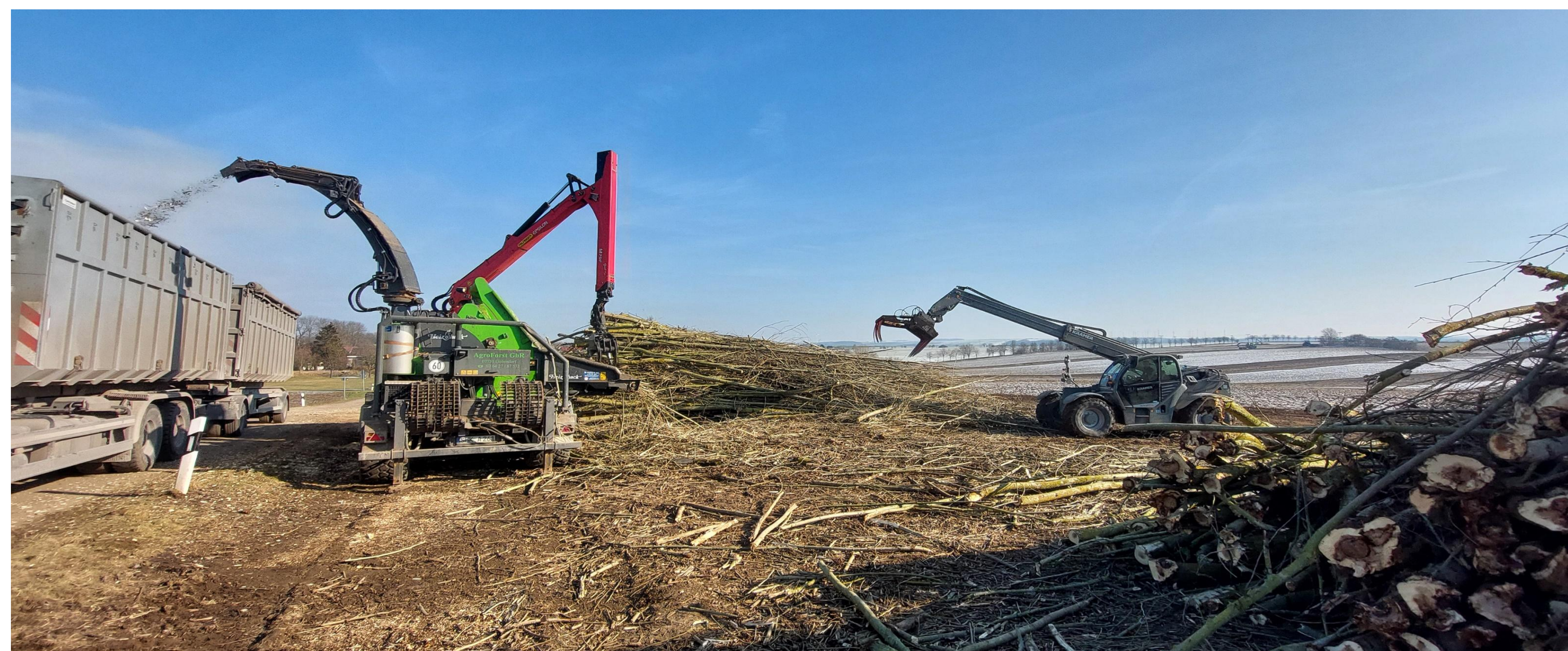
Abb. 4: Die Produktion der Hackschnitzel erfolgte parallel zur Ernte. Hierfür kam ein Traktor (ca. 400 PS) mit angehängtem Hacker zum Einsatz. Das Hackgut wurde an verschiedene Biomasseheizkraftwerke in Mitteldeutschland geliefert.
